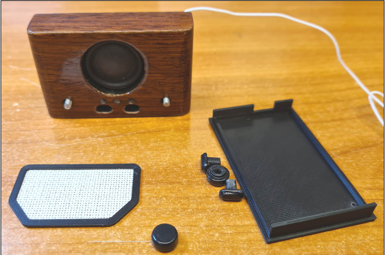
3D-printede knapper og baklokk, samt høyttalerdeksel med et finmasket broderistoff.
